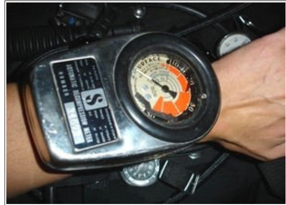
Nomogramma di decompressione e uno dei primi computer subacquei analogici, 1970
