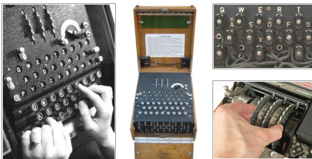
Enigma: si notano la tastiera, le lampadine, i rotori e un particolare degli spinotti
