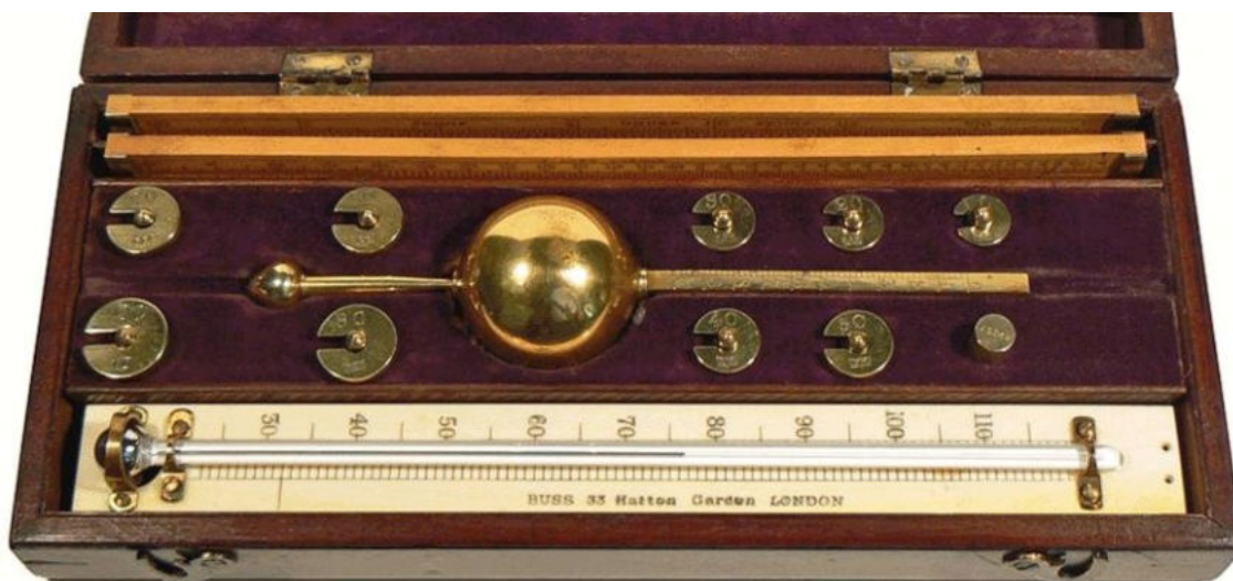
Set con due regoli ed idrometro per la tassazione degli alcoolici, ca. 1870
