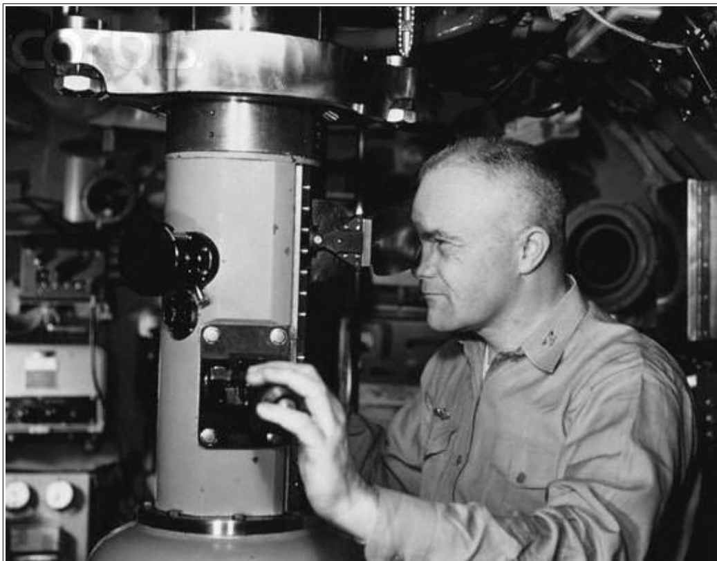
Sestante inserito nel periscopio per la circumnavigazione sottomarina senza mai emergere del sommergibile USS Triton (SSRN-586) nel 1960
