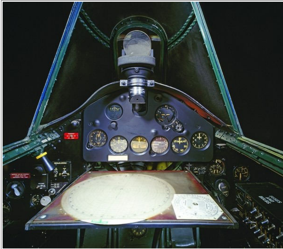
Una mano per i calcoli ed una per pilotare sul Wildcat (notare il sestante a periscopio e i regoli), ma la cloche è nascosta sotto il tavolino estraibile
