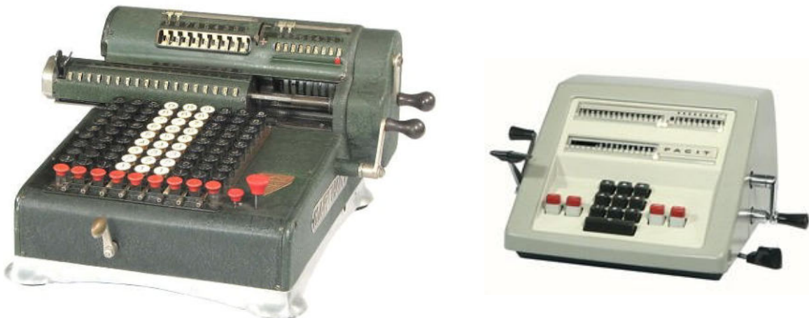
Una delle prime Odhner con tastiera, ca. 1925, e un modello del 1965 (© John Wolff)
