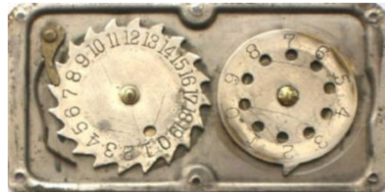
Credit card size: lo Stephenson Adder ed il suo meccanismo, ca. 1890
