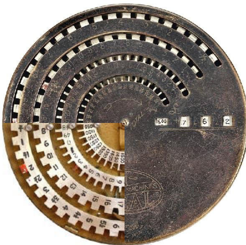
Spaccato del BriCal Calculator per la valuta britannica, ca. 1900
